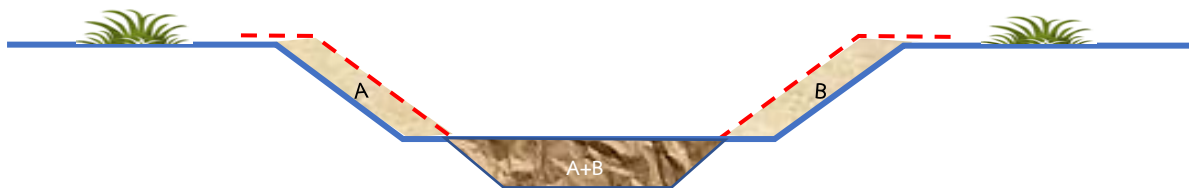
ภาพที่ ๒๒ การขุดลอกที่ไม่มีประสิทธิภาพ ปริมาณดินที่ขุดลึกเท่ากับปริมาณดินที่นำมาแปะด้านข้างของคันดิน โดยพื้นที่หน้าตัดสำหรับให้น้ำไหลผ่านมีพื้นที่เท่าเดิม
